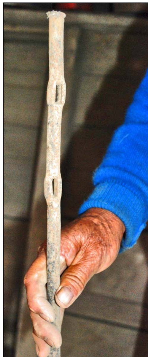
Varilla lisa de ½" pulgada de diámetro con ranuras para el armado de la tapialera (Foto JUV 2010)
